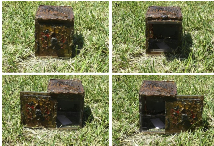
Figure 1. The 'vervetable': (a) door closed, (b) door lifted, (c) door slid to left, (d) door slid to right.
